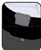
> Revissez la collerette à fond, puis revenez légèrement en arrière jusqu'à ce que la butée d'arrêt s'enclenche dans l'un des 4 crans présents sur la collerette. **(La purge doit être ouverte, d'un ou deux tours.)**
